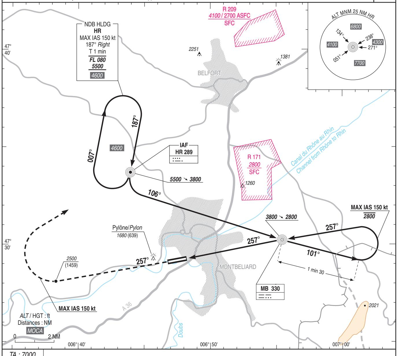
API : Monter au QDR 257° MB (RM 257°). A 2500 (1459), tourner à droite vers HR en montée vers 5500 (4459). Ne pas tourner avant le MAPT. Monter à 2600 (1559) avant d'accélérer en palier.
