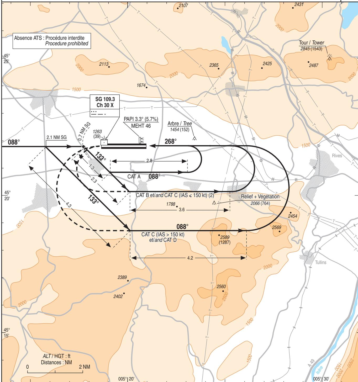
MNM AD : distances verticales en pieds, VIS en mètres./Vertical distances in feet, VIS in metres. REF HGT : ALT AD
