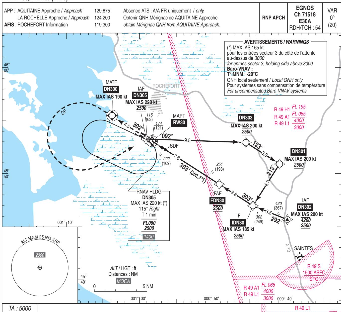
API : Monter dans l'axe jusqu'à **DN300**, puis tourner à gauche direct vers **DN305** en montée vers **2500** (2447).
