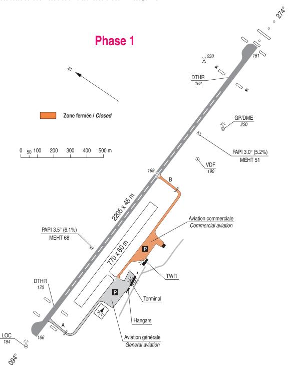
Rabotage de la couche de roulement parking commercial et partie TWY « B ». Pose couche enrobé.
