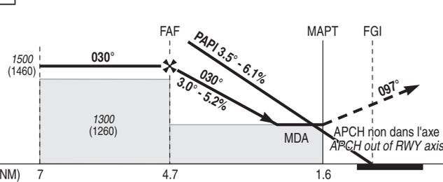
API : Au MAPT, tourner à droite pour intercepter et suivre le RDL 097° FGI (RM 097°) en montée vers 4000 (3960). A 13 NM DME FGI, intégrer l'attente MASAL à 4000 (3960). Monter à 2000 (1960) avant d'accélérer en palier.
