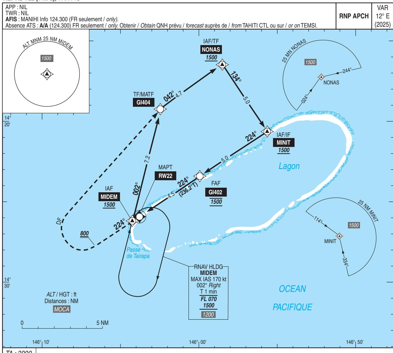
API : Monter RM 224°, à 800 (778) tourner à droite direct vers GI404 puis poursuivre vers NONAS en montée vers 1500 (1478).
