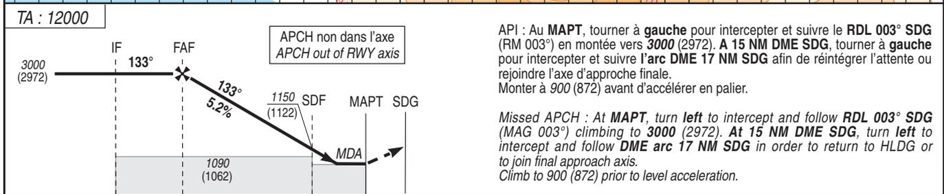
API : Au MAPT, tourner à **gauche** pour intercepter et suivre le RDL 003° SDG (RM 003°) en montée vers 3000 (2972). A 15 NM DME SDG, tourner à **gauche** pour intercepter et suivre l'arc DME 17 NM SDG afin de réintégrer l'attente ou rejoindre l'axe d'approche finale.
