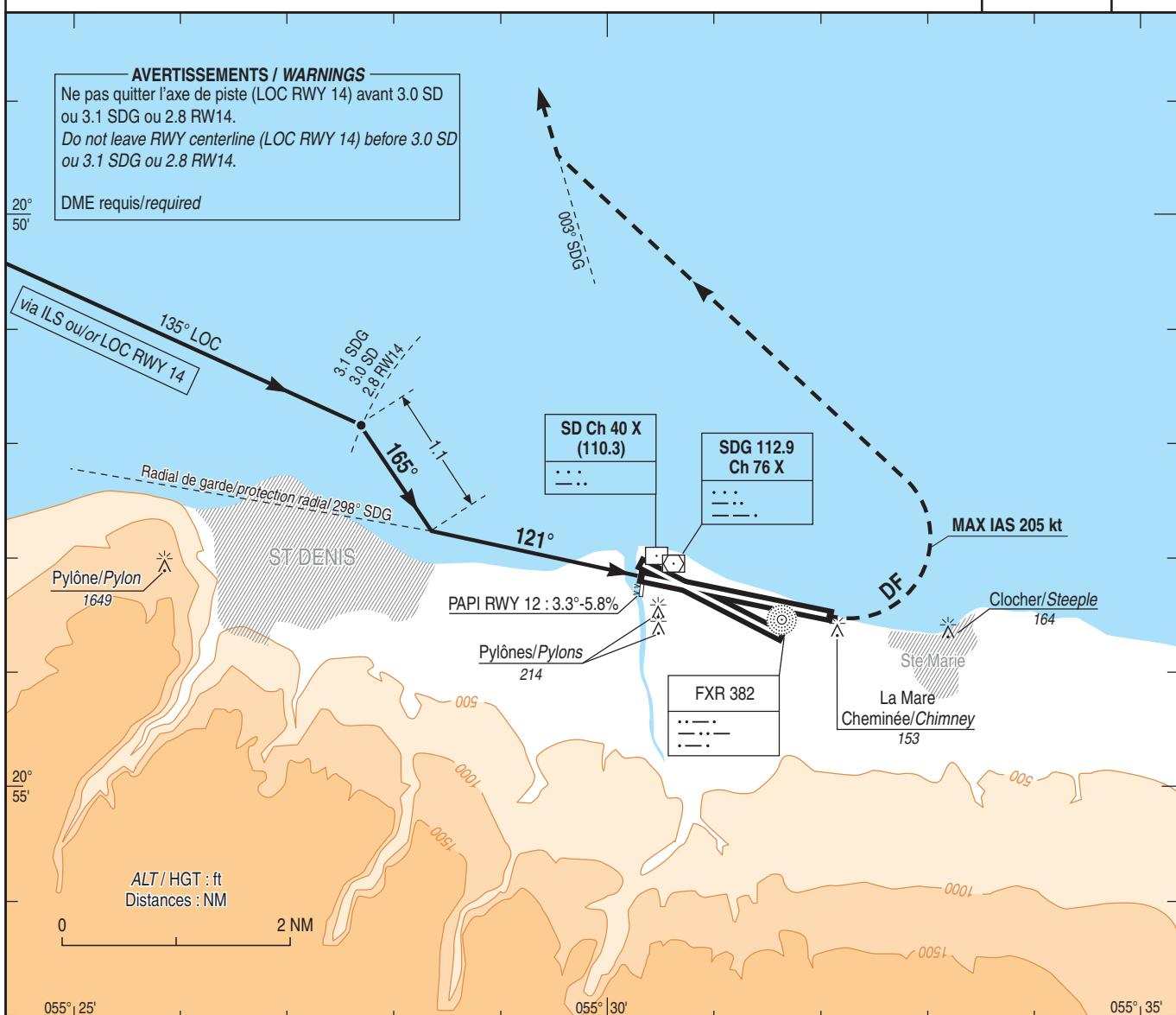
Atterrissage manqué : Tourner à gauche pour rejoindre et suivre le RDL 003° SDG (RM 003°) en montée vers 3000 (2934) afin de se raccorder sur l'API de la procédure d'approche.
