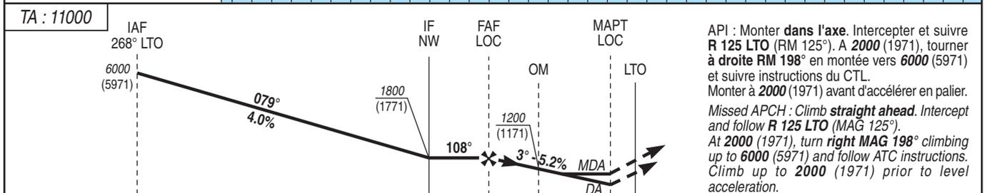
API : Monter dans l'axe. Intercepter et suivre R 125 LTO (RM 125°). A 2000 (1971), tourner à droite RM 198° en montée vers 6000 (5971) et suivre instructions du CTL. Monter à 2000 (1971) avant d'accélérer en palier.
