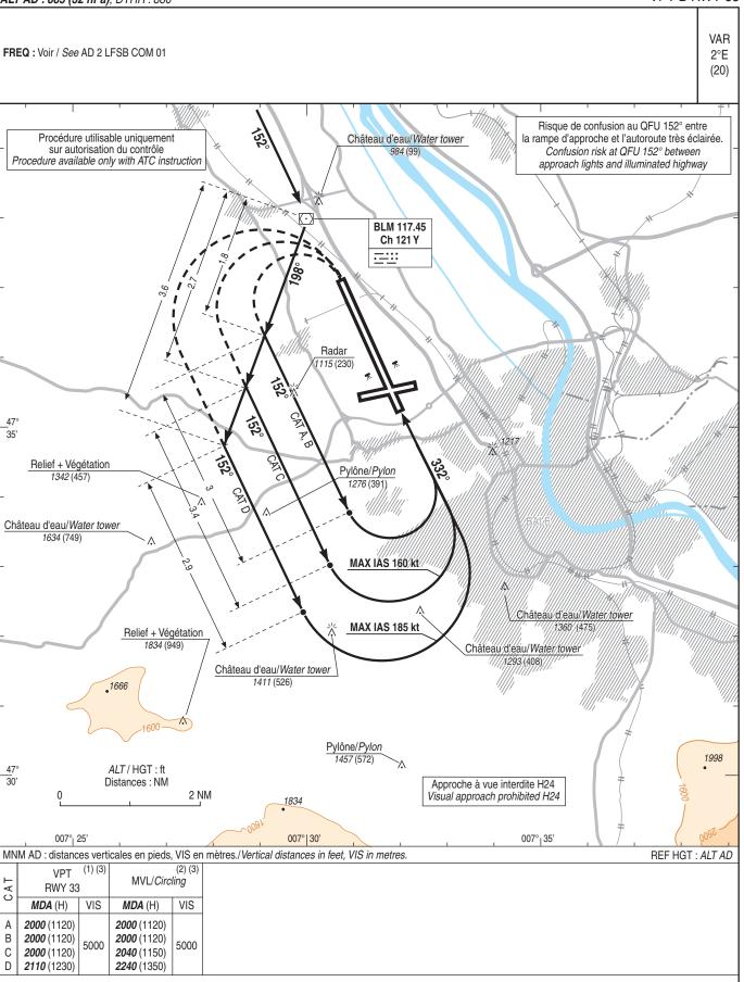
Observations: (1) Suite à finale RWY 15. (2) MVL RWY 33, VIS 5000 m. (3) Ne pas descendre en dessous de la MDA avant le début du segment rectiligne d'alignement
