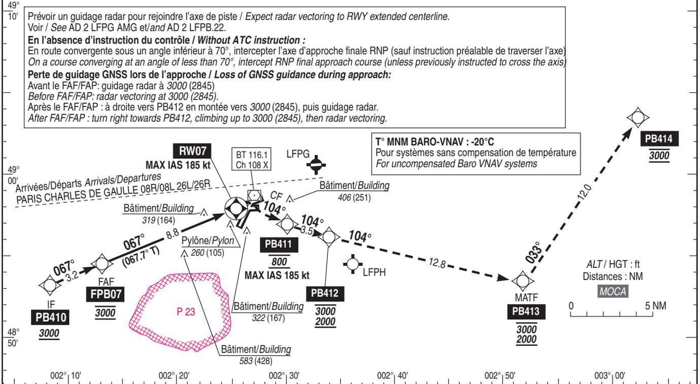
Prévoir un guidage radar pour rejoindre l'axe de piste / Expect radar vectoring to RWY extended centerline.
