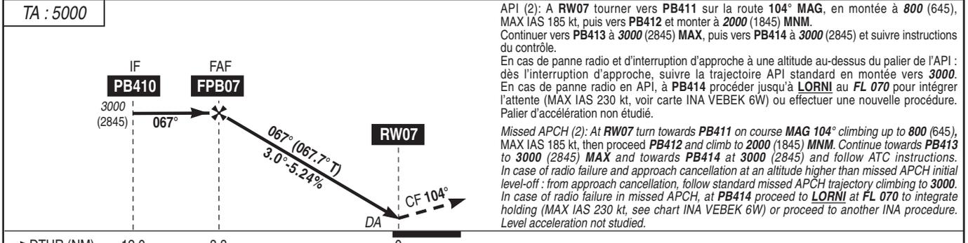
API (2): A RW07 tourner vers PB411 sur la route 104° MAG, en montée à 800 (645), MAX IAS 185 kt, puis vers PB412 et monter à 2000 (1845) MNM. Continuer vers PB413 à 3000 (2845) MAX, puis vers PB414 à 3000 (2845) et suivre instructions du contrôle.
